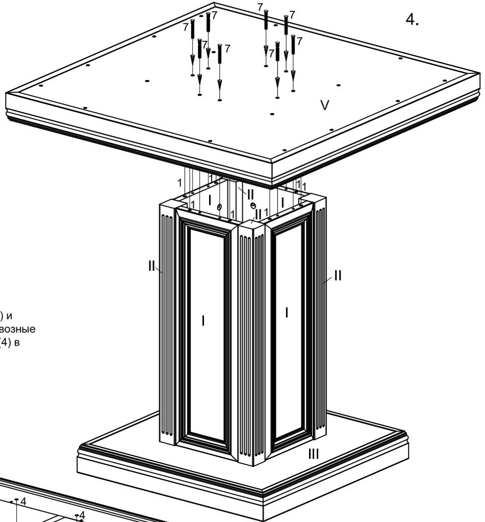
Установить на подстолье (V) столешницу (IV) и зафиксировать, завернув винты (5 и 6) через сквозные отверстия в подстолье (V) в цанговые футорки (4) в столешнице (IV) (рис. 5).
