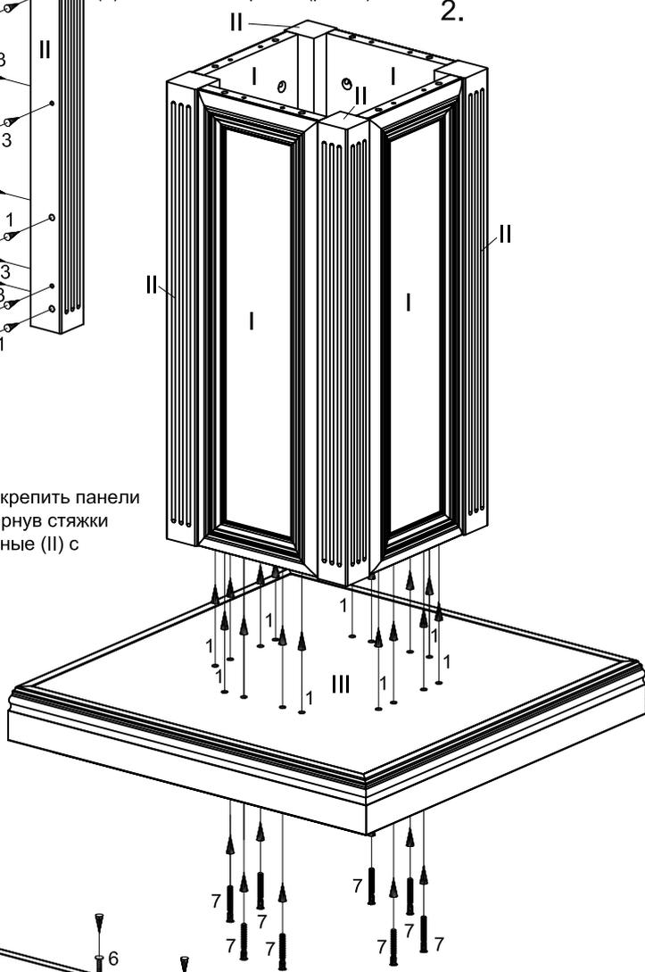
В глухие отверстия  $\varnothing 8$  мм в основании (III) вбить шканты (1) (рис. 2). Закрепить панели декоративные (I) в сборе с колоннами угловыми (II) на основании (III), завернув стяжки директа (7) через сквозные отверстия в основании (III) в панели декоративные (II) с помощью шестигранного ключа (8) (рис. 2).
