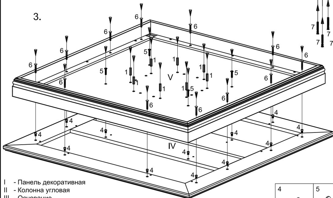
Положить подстолье на чистую ровную поверхность глухими отверстиями  $\varnothing 8$  мм вверх. В глухие отверстия  $\varnothing 8$  мм вбить шканты (1) (рис. 3).
