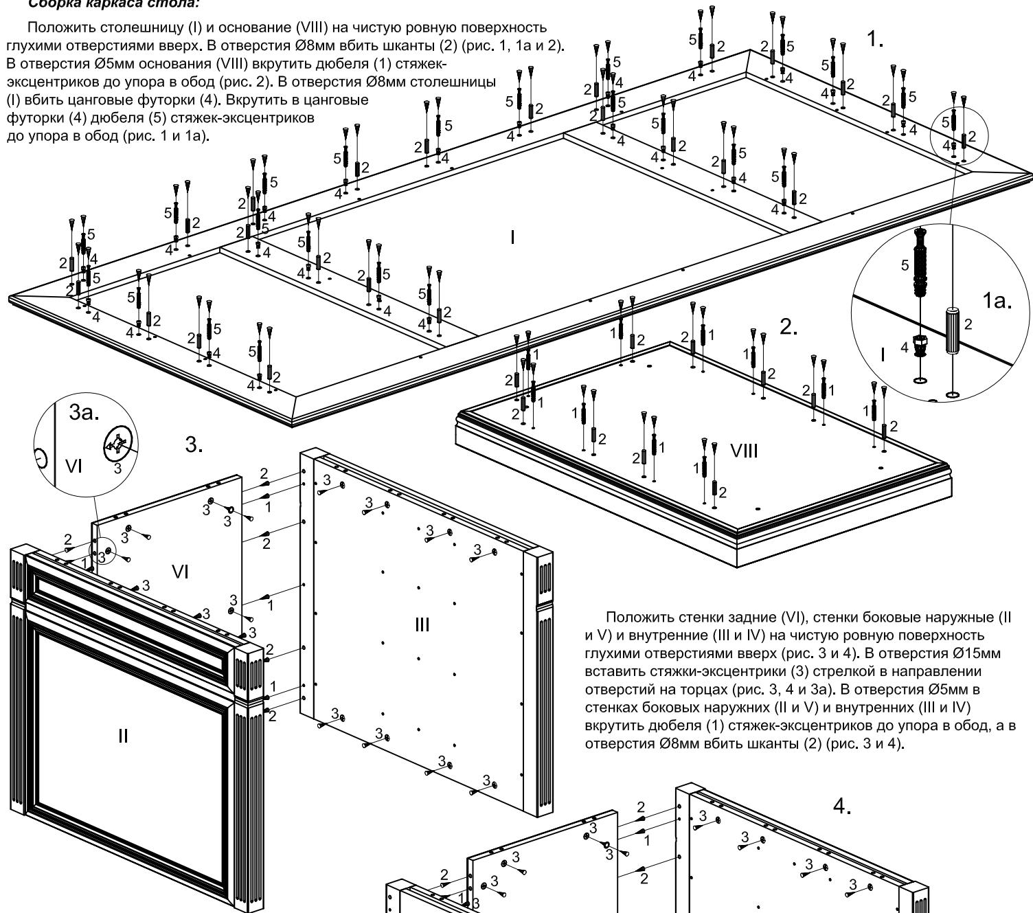
Положить стенки задние (VI), стенки боковые наружные (II и V) и внутренние (III и IV) на чистую ровную поверхность глухими отверстиями вверх (рис. 3 и 4). В отверстия Ø15мм вставить стяжки-эксцентрики (3) стрелкой в направлении отверстий на торцах (рис. 3, 4 и 3а). В отверстия Ø5мм в стенках боковых наружных (II и V) и внутренних (III и IV) вкрутить дюбеля (1) стяжек-эксцентриков до упора в обод, а в отверстия Ø8мм вбить шканты (2) (рис. 3 и 4).
