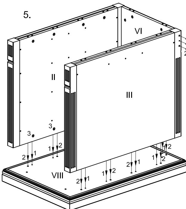
Установить стенки боковые наружные (II и V) и внутренние (III и IV) в сборе со стенками задними (VI) на основания (VIII) и зафиксировать, поворачивая стяжки-эксцентрики (3) отверткой по часовой стрелке (рис. 5).
