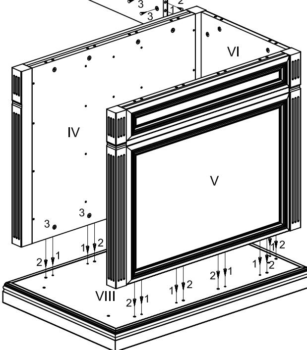
Положить панель переднюю (VII) глухими отверстиями вверх. В отверстия Ø15мм вставить стяжки-эксцентрики (3) стрелкой в направлении отверстий на торцах (рис. 5). В боковины внутренние (III и IV) вбить шканты (2) и вкрутить дюбеля (1) стяжек-эксцентриков до упора в обод (рис. 5).
